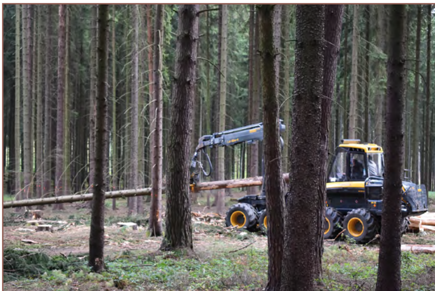
Obr. 4: Odkorňování pomocí harvestoru se speciálně upravenou hlaví
