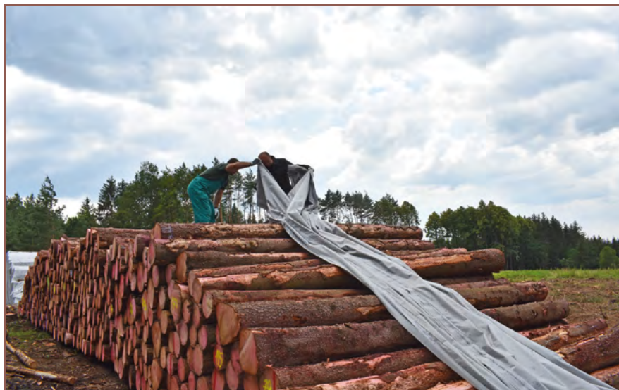
Obr. 20: Počáteční fáze zakrývání skládky
