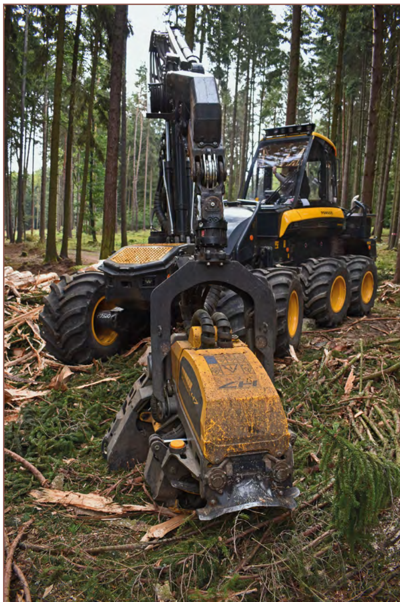
Obr. 7: Harvester s odkorňovací hlaví
