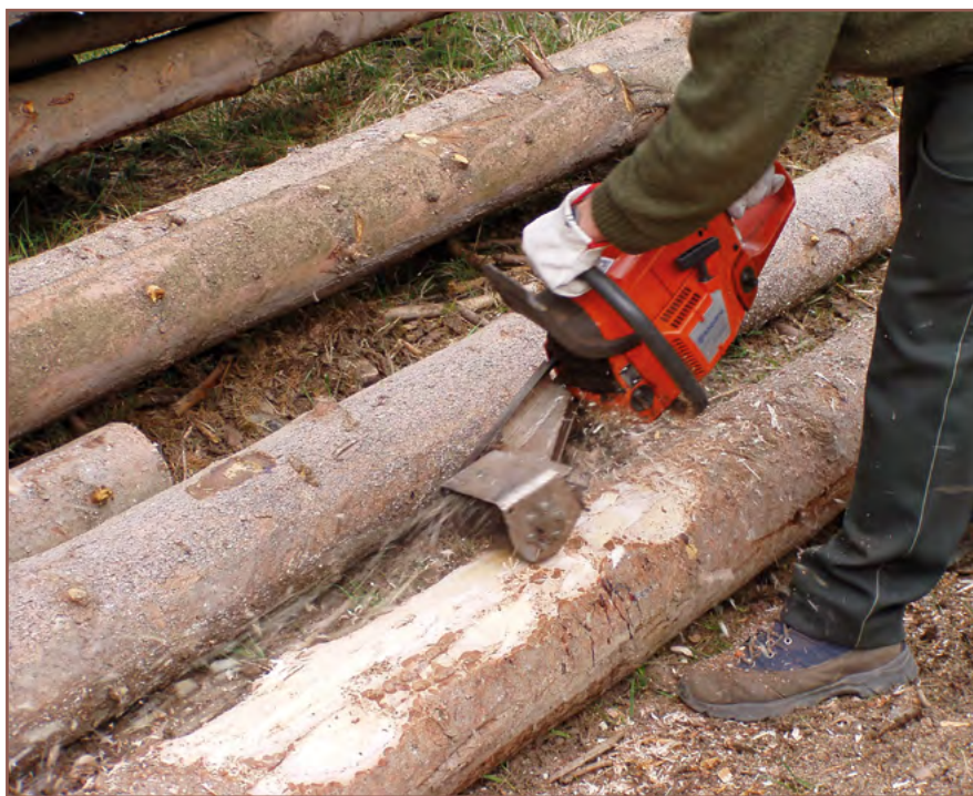
Obr. 2: Odkorňování pomocí adaptéru na motorovou pilu
