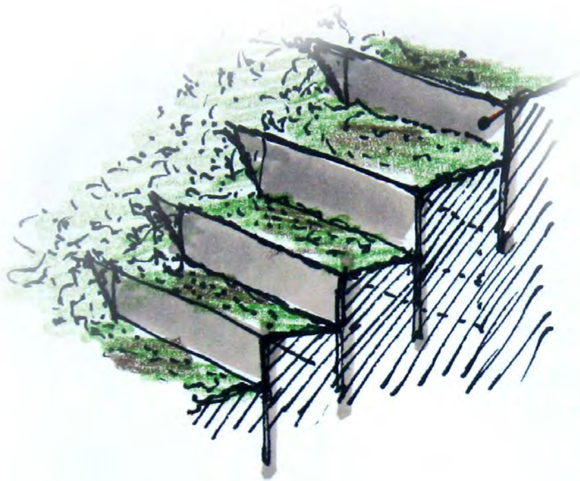
Vyrovnání terénu pomocí ocelových plátů
