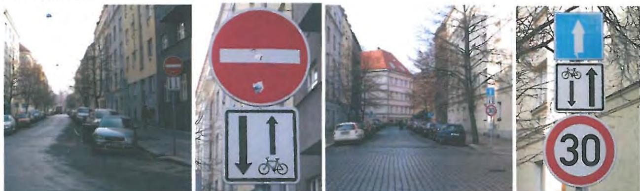
Ukázka provedení pouze se svislým dopravním značením s využitím E 13; omezení na 30 km/h je přímo v místě doplněno z důvodu absence zóny Tempo 30 (Praha, Dr. Zikmunda Wintra)
