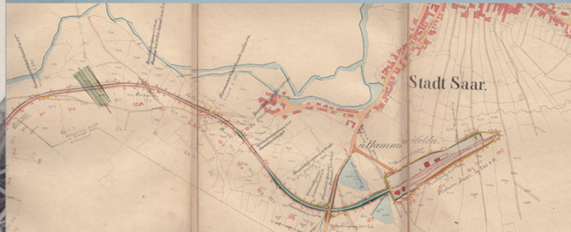
▲ Trasa původní dráhy z Německého Brodu do stanice Žďár, která byla do června 1905 konečnou stanicí. Na pláncu je v levé horní části zakresleno křížení s novou dvojkolejnou dráhou, za níž byl postaven viadukt přes řeku Sázavu. 6. prosince 1953 tato dráha nahradila tu původní z roku 1898 (SaZ Sázava)
